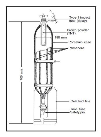
Figure 1: Type 50 Uji Bomb<sup>35</sup>
